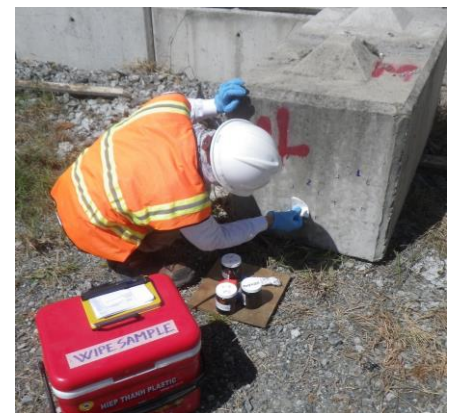
Thu thập mẫu lau ở bề mặt tường kết cấu xử lý (Ảnh: CDM Smith)
