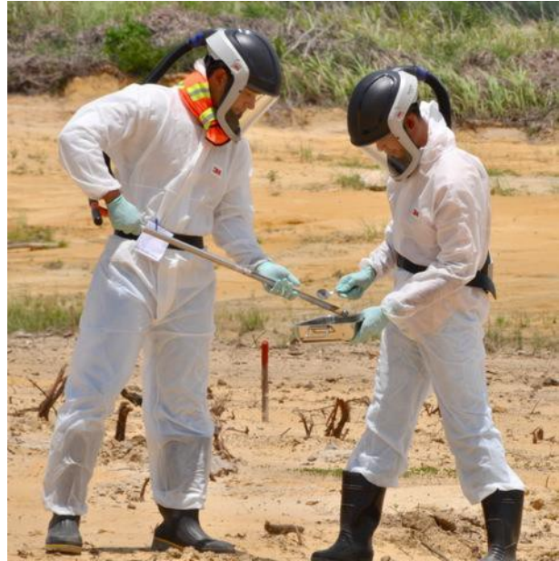
Lấy mẫu đất trong địa bàn Dự án Xử lý Môi trường Ô nhiễm Dioxin tại sân bay Đà Nẵng. Ảnh: USAID Việt Nam
